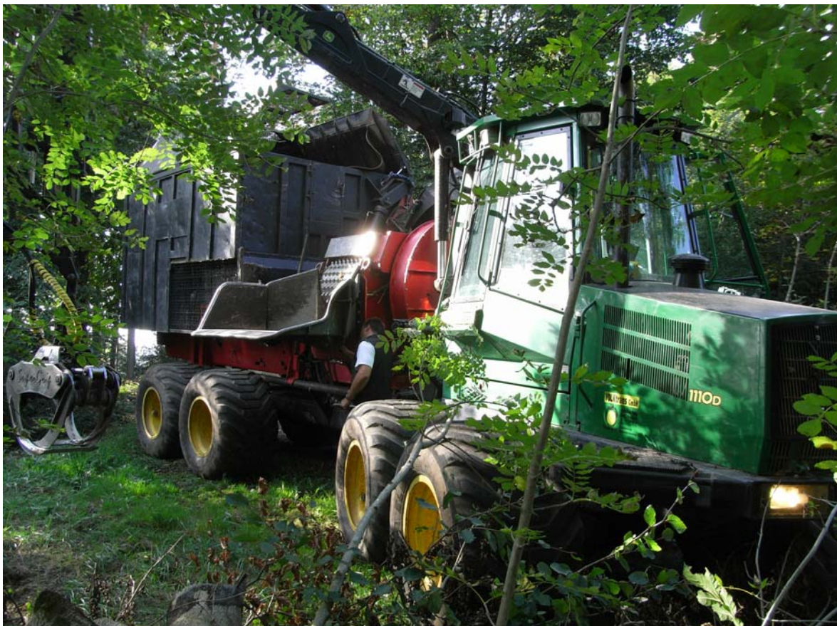
Auf Forwarder aufgebauter Hacker mit 20m 3 Bunker für Einsätze im Bestand. (Einsatz in Elgg Sommer 2009)
